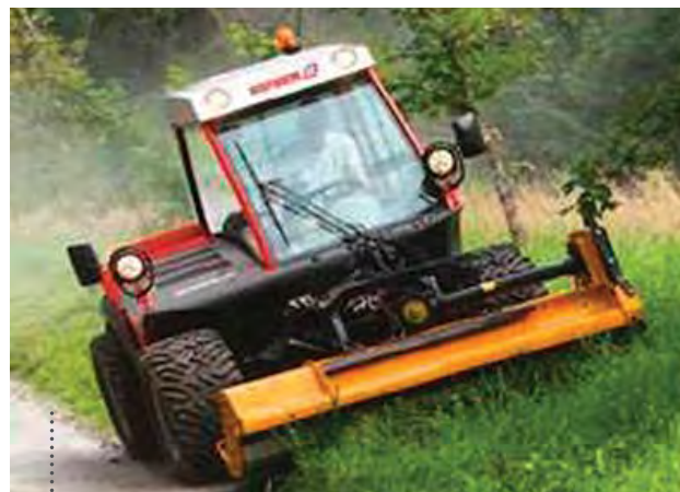
Utilisation expérimentale d'un « Métrac » pour les tontes difficiles (grandes pentes)
