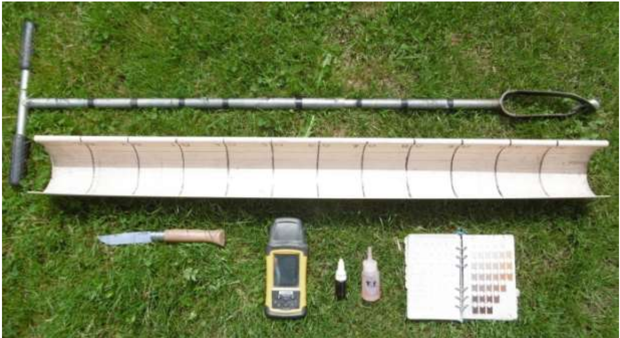
Figure 2 : Matériel du pédologue : tarière Edelman, gouttière graduée, couteau, pocket PC/GPS, test acide chlorhydrique, test Fer, charte Munsell (S.DOUARD-CBNB, 2015)
